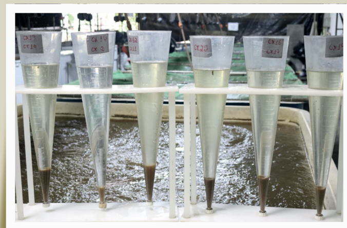
Tanque de produção aquícola com BFT e cones Imhoff usados no controle do volume de bioflocos
